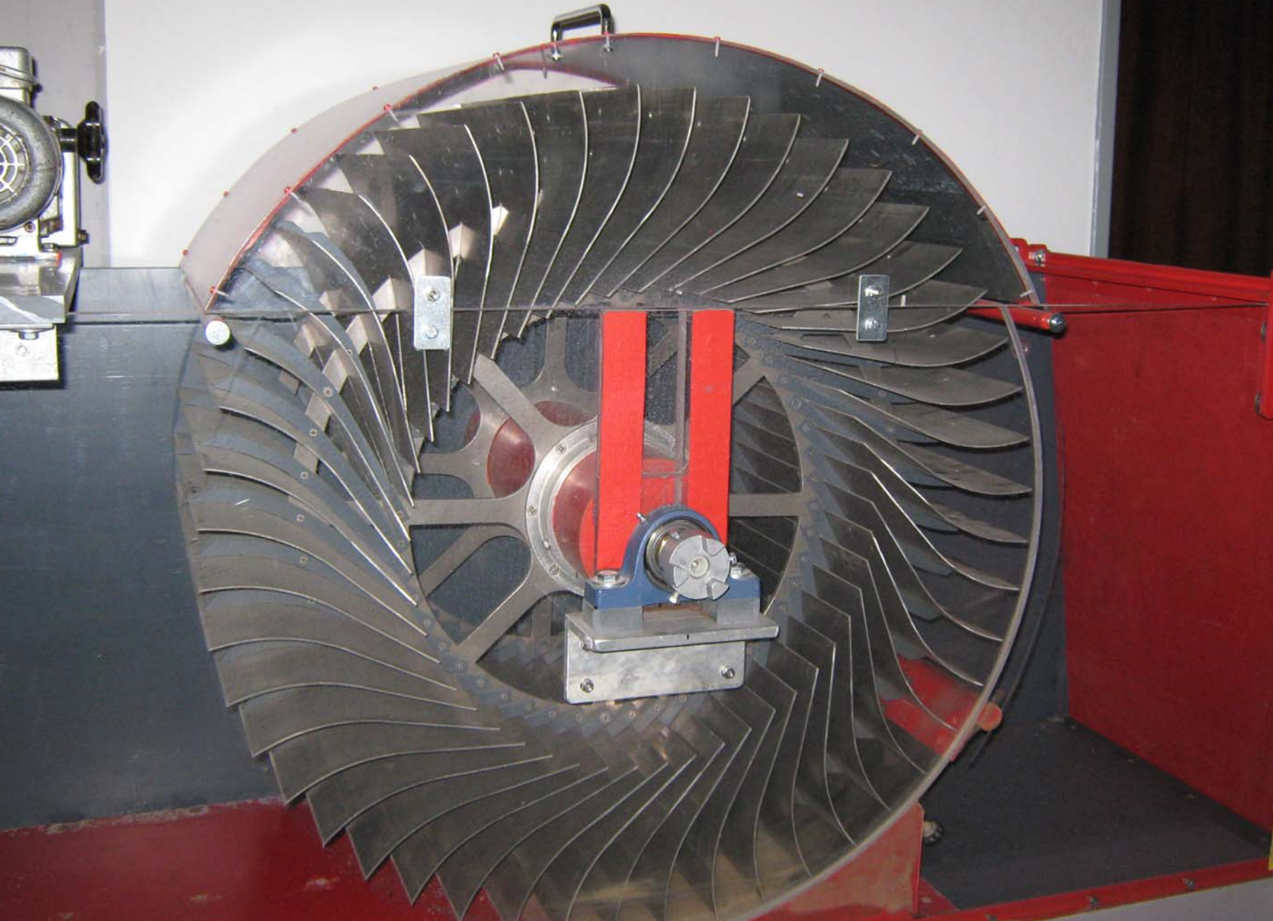
Modell: Schaufelwasserrad zur Energiegewinnung
